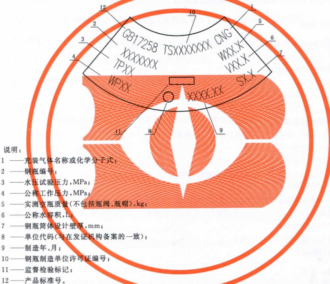
图 9 钢瓶钢印标记示意图
